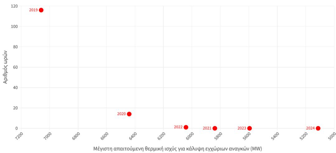
**Διάγραμμα 3: Συσχέτιση αριθμού ωρών που οι εγχώριες ανάγκες σε θερμική ισχύ ξεπέρασαν την εγκατεστημένη ισχύ μονάδων αερίου (6.037 GW) με τη μέγιστη απαιτούμενη θερμική ισχύ.**
